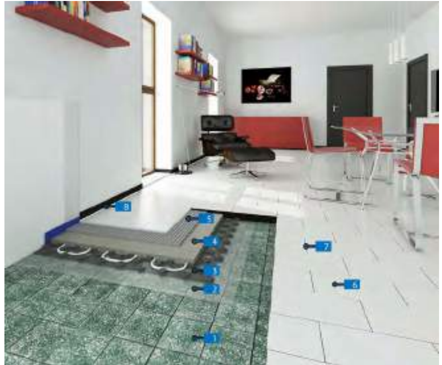
SISTEMA DE COLOCACIÓN DE GRES PORCELÁNICO FINO SOBRE SISTEMA DE CALEFACCIÓN RADIANTE DE BAJO ESPESOR
